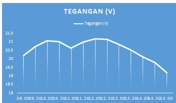
Gambar 11. Grafik pengujian tegangan (V) panel surya *monocrystalline*(hari ke 3)
