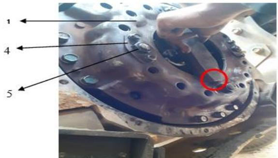
Gambar 20. Proses penyetelan *Release lever*.
