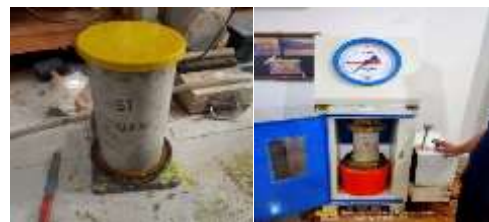
Gambar 7. Benda uji dan pengujian kuat tekan beton
