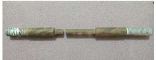
Gambar 13. Hasil patahan benda uji tarik
