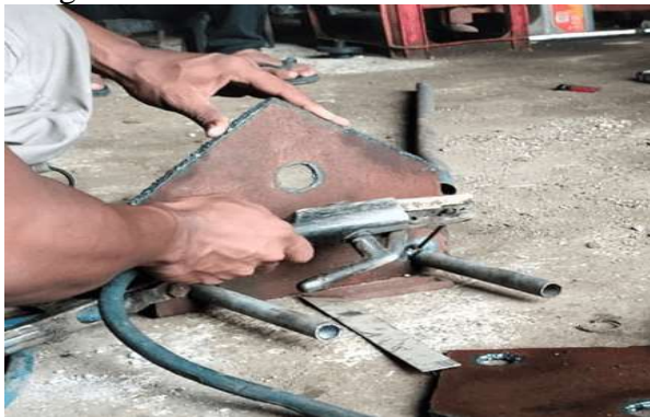
Gambar 19. Proses penggabungan plat dan besi fork
