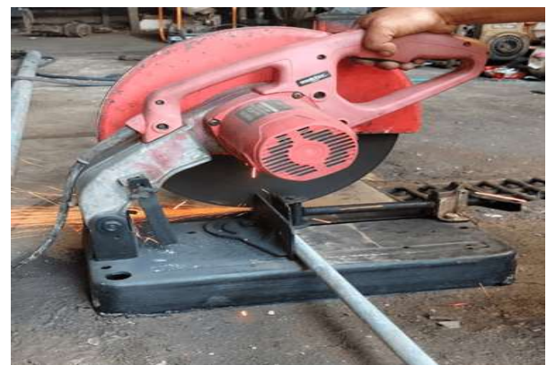
Gambar 17. Proses pemotongan besi pipa
