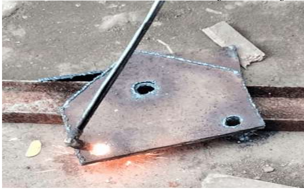
Gambar 18. Proses Pembentukan Plat
