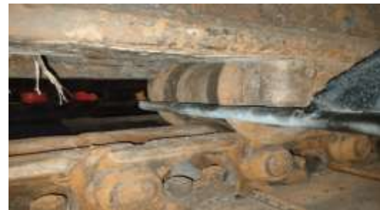
Gambar 21. Posisi tools menyanggah track roller
