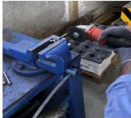
Gambar 13. Proses Pemotongan Besi As
