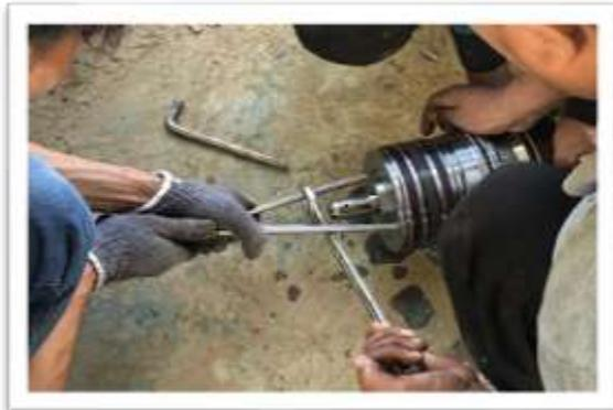
Gambar 8. Pelepasan dan Pemasangan *Piston Seal Cylinder* Menggunakan Alat Bantu Tidak Standar
