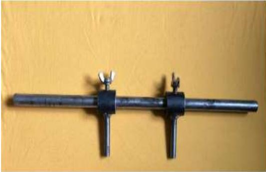
Gambar 16. Alat Bantu Khusus Pelepasan dan Pemasangan *Piston Seal Cylinder*
