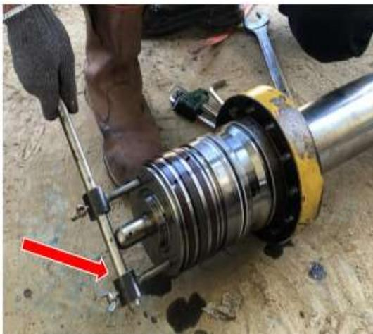
Gambar 17. Pelepasan dan Pemasangan *Piston Seal Cylinder* Menggunakan Alat Bantu Khusus
