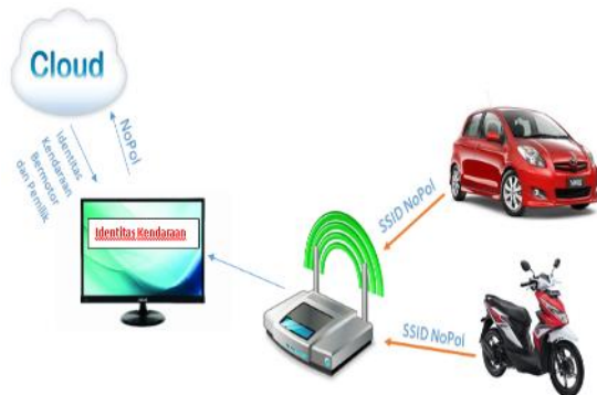
Gambar 6. Blok Diagram Sistem
