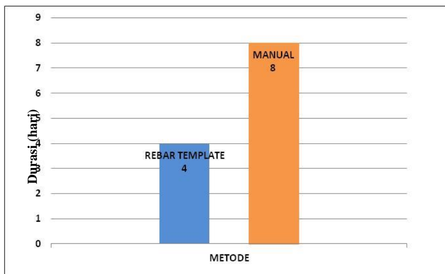
Grafik perbandingan durasi fabrikasi per lantai antara metode rebar template dan manual
