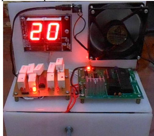
Gambar 6. Realisasi sistem pengendali suhu
