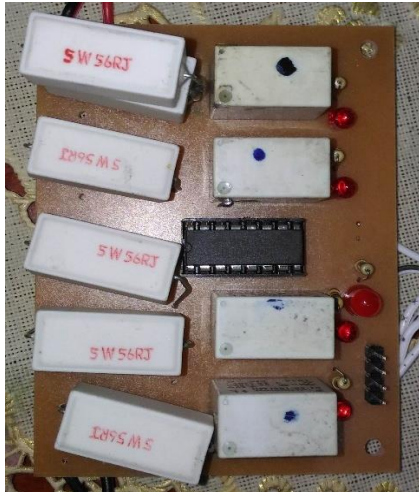
Gambar 8. Relay pembagi tegangan
