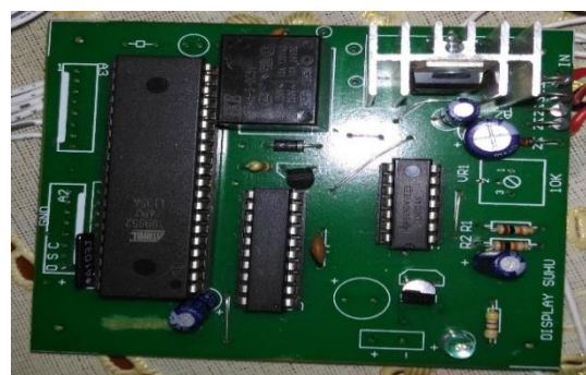
Gambar 7. Rangkaian sensor, mikrokontroler, dan konverter analog ke digital
