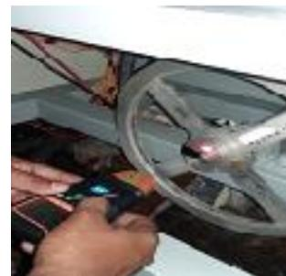
Gambar 21. Pengukuran putaran turbin
