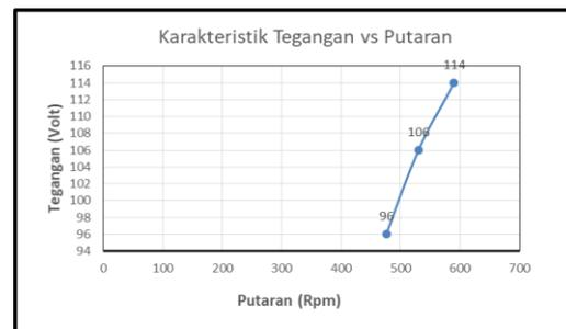
Gambar 24. Grafik putaran vs tegangan generator tanpa beban
