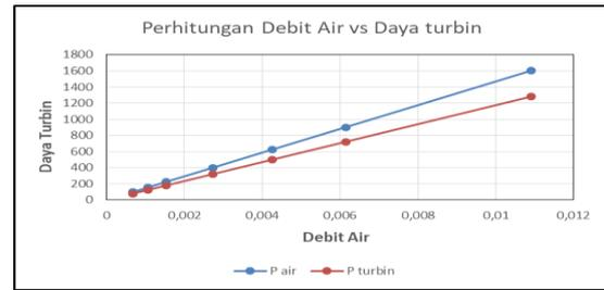
Gambar 20. Grafik perbandingan debit air vs daya turbin
