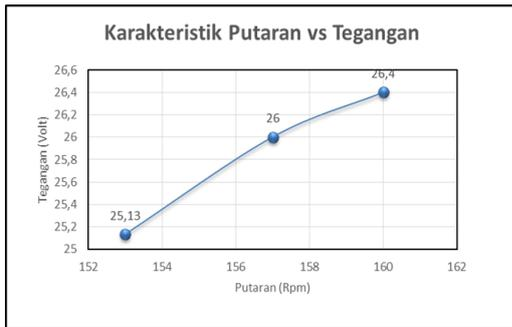
Gambar 25. Grafik putaran vs Tegangan Generator dengan beban
