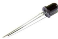
Gambar 4. Flame sensor (Kusuma, 2013)
