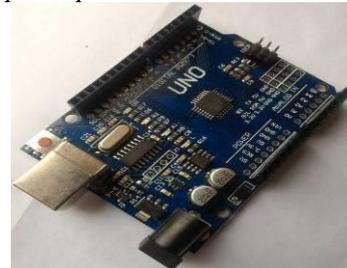
Gambar 16. Rangkaian Arduino Uno
