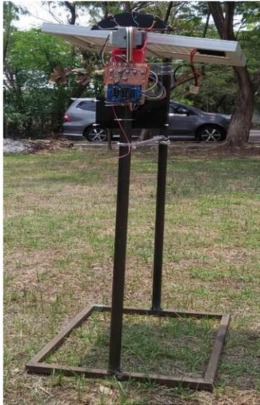
**Gambar 4.** Konstruksi Mekanik Solar Tracking
