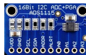
Gambar 3. Bentuk fisik Adafruit 4-Channel ADC Breakouts berbasis IC ADS1115 Texas Instrument.
