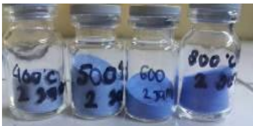
Gambar 5.1 Produk nanopartikel \text{CoAl}_2\text{O}_4 hasil kalsinasi pada suhu 400\text{--}800^\circ\text{C}
