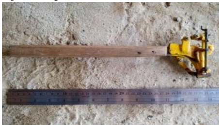
Gambar 11. Alat sadap karet yang telah di manufaktur
