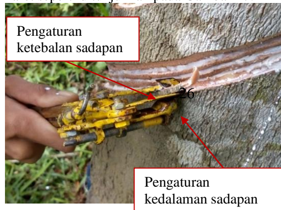
Gambar 17. Pengaturan kedalaman dan ketebalan alur sadapan
