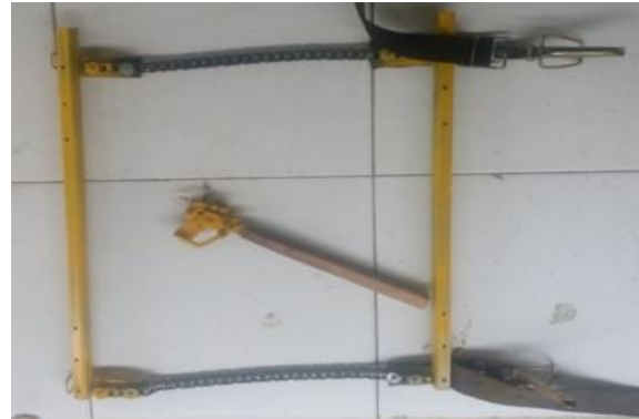
Gambar 12. Alat pengatur kemiringan sudut sadapan yang telah dimanufaktur
