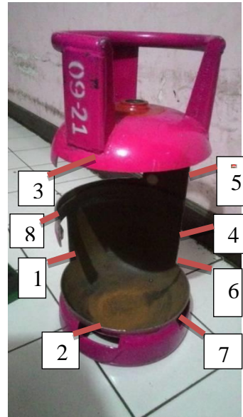
Gambar 3. Lokasi pengukuran ketebalan shell tabung gas
