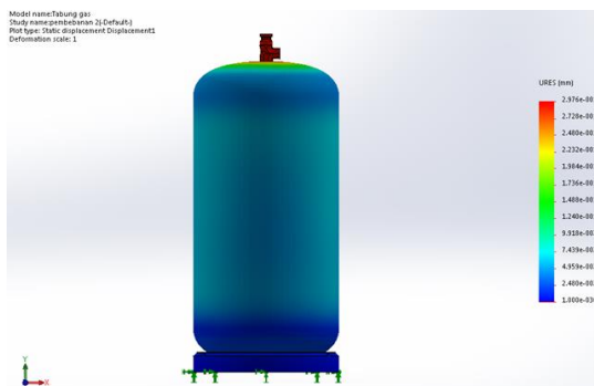
Gambar 7. Displacement pada tekanan internal 31 kg/cm 2
