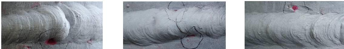
Gambar 4. Hasil pemeriksaan *Dye Penetrant Test* dengan menggunakan elektroda terekspos
