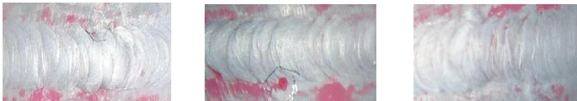
Gambar 5. Hasil pemeriksaan *Dye Penetrant Test* dengan menggunakan elektroda tidak terekspos
