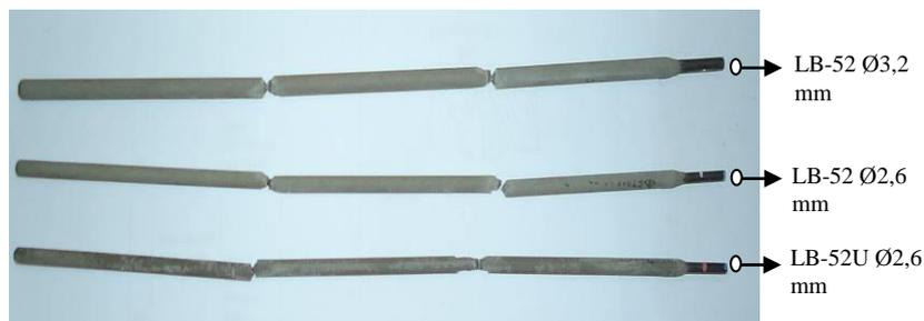
Gambar 3. Elektroda dibagi menjadi 3 bagian untuk uji Gravimetry
