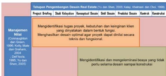
Gambar 3 Peran VM pada Pengembangan real estat (diadopsi dari Dell'Isola, 1995; Connaughton dan Gren, 1996; Cha, 2003; Kelly, Male dan Graham, 2004; Yu dan Shen, 2005)
