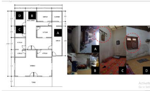
Gambar 4. Kondisi Beberapa Ruang Dalam Sebuah Hunian Penderita TB di Kabupaten Kebumen dengan Bukaannya Ventilasi atau Pencahayaan yang Tidak Sesuai Standar
