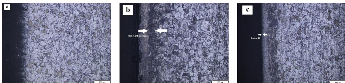
Gambar 2. Struktur mikro perbesaran 200x (a) spesimen tanpa perlakuan (b) perlakuan shot peening 20 menit (c) lapisan deposisi sputtering TiN pada perlakuan shot peening 20 menit
