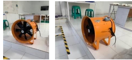
Gambar 111 Komponen motor fan dari desain terowongan angin
