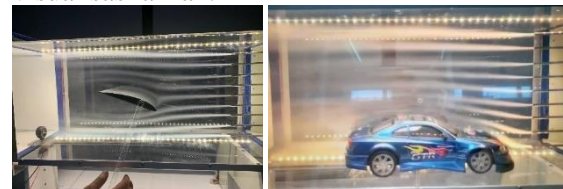
Gambar. 3.4 Hasil implemetasi dan evaluasi aliran pada benda uji dalam wind tunnel pada v = 20\text{m/s}
