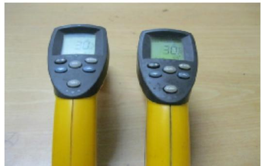
Gambar 5. Infrared Thermogun Alat Pengukur Suhu
