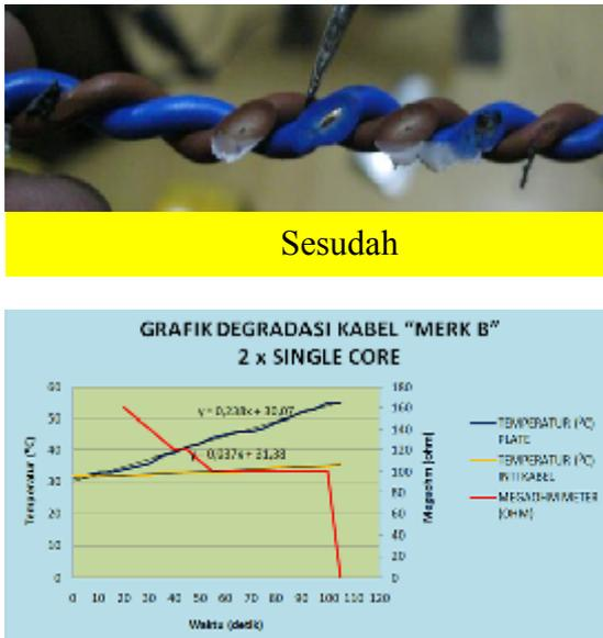
Gambar 12. Grafik Karakteristik Degradasi tahanan Isolasi Kabel B 2 x Single Core
