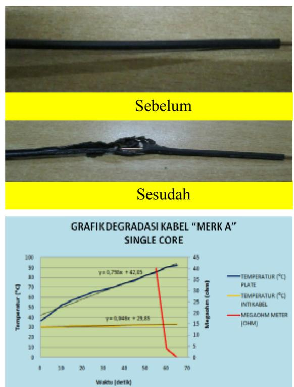
Gambar 9. Grafik Karakteristik Degradasi Tahanan Isolasi Kabel A Single Core
