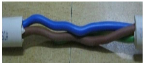
Gambar 2. Kontruksi dari kabel NYM  $3 \times 1,5 \text{ mm}^2$  merk **B**
