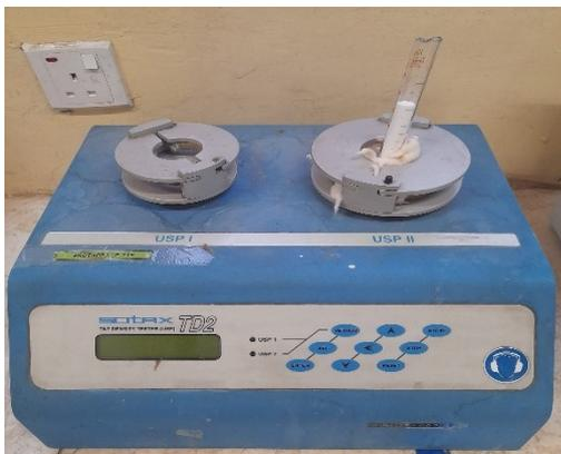
Gambar 4. 5 Uji kepadatan sampel menggunakan alat tap dencity meter
