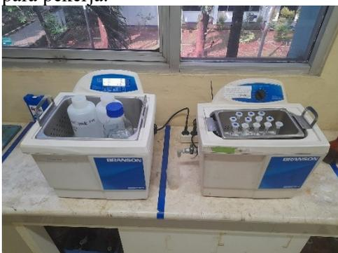
Gambar 4. 3 Pelarutan sampel menggunakan alat ultrasonic
