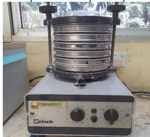
Gambar 4. 4 Uji ukuran sampel menggunakan alat shieving machine
