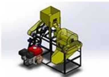
Gambar 2 Mesin Pencetak Pelet Maggot Sistem Extruder karya Lusi, N., Trianasari, E., Kusuma, A. L., & Al Hakim, S. L. 2020
