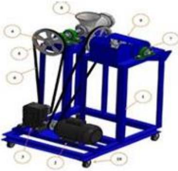
Gambar 4. Mesin Pelet dengan Sistem Transmisi Gearbox atau Pulley terhadap Kapasitas karya Iskandar, D. (2022)
