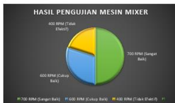
Gambar 10. Grafik Hasil Data Alat Pengujian Mixer Pada Mesin Pencetak Pelet Unggas
