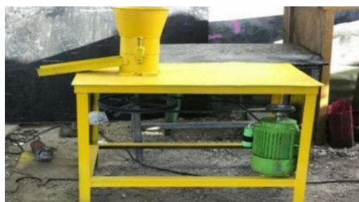
Gambar 1. Pencetak Pelet Untuk Pakan Ternak Farus, F., Jasron, J. U., Selan, R. N., & Weo, N. A. (2024)
