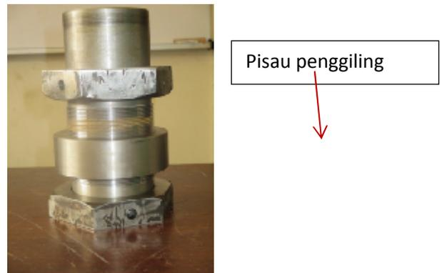
Gambar 7. Unit Penyetel Jarak Kerenggangan Pisau dan pisau penggiling
