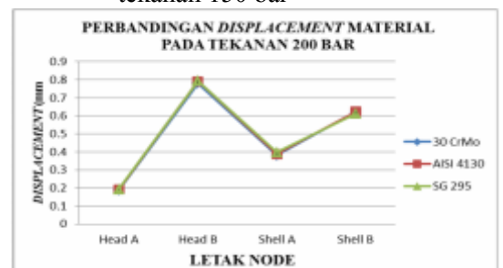
Gambar 7. Hasil uji displacement material pada tekanan 200 bar
