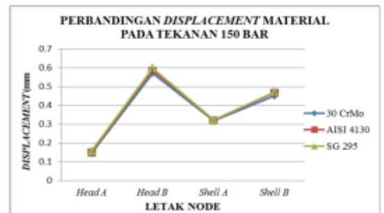
Gambar 6. Hasil uji displacement material pada tekanan 150 bar
