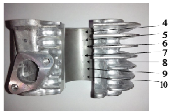
Gambar 4. Pengujian Kekerasan ( Brinell ) 3 Titik pada Blok Silinder Liner Al-Si
