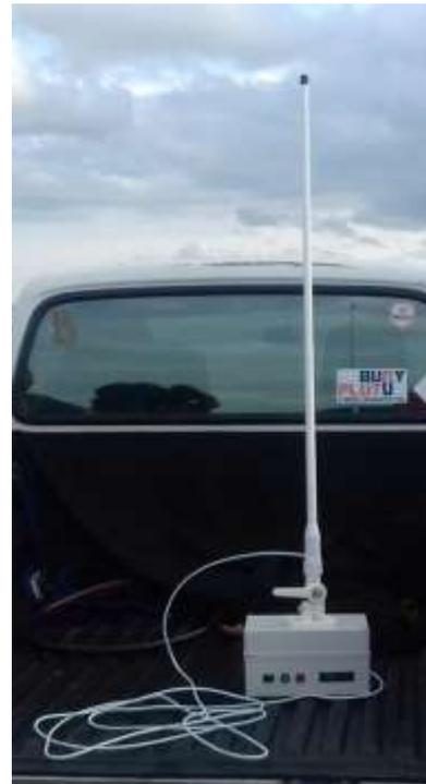
Gambar 8c Purwarupa perangkat AIS Transmitter lengkap dengan Antena
