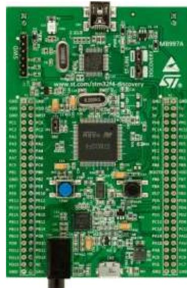
Gambar 5 Mikrokontroler STM32F4
