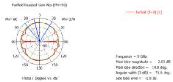
Gambar 18. Pola Radiasi Elevasi pada Frekuensi 9 GHz
