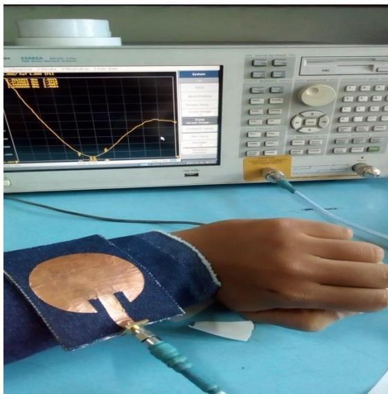
**Gambar 13.** Pengukuran VSWR dan Bandwidth Kondisi *On Body*
