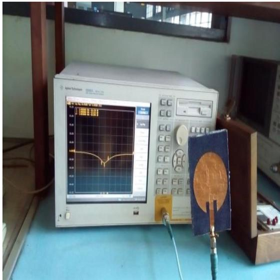
**Gambar 12.** Pengukuran VSWR dan Bandwidth Kondisi *Free Space*
