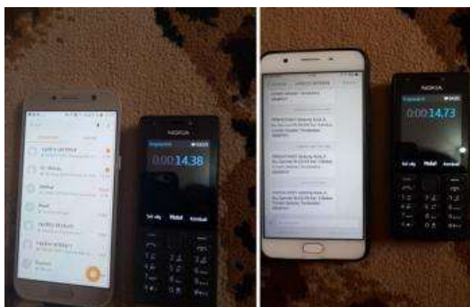
Gambar 17. Pengujian pengiriman pesan pendek dari sistem ke nomor yang diregistrasikan
