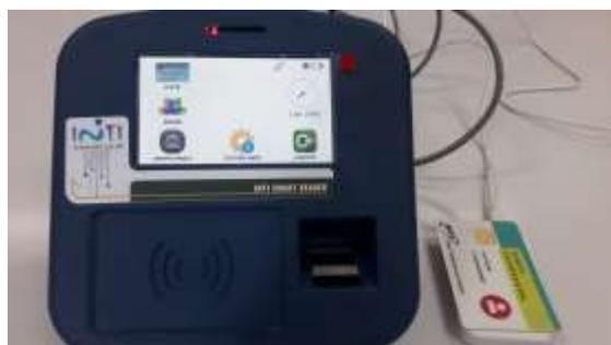
Gambar 2. Tampilan fisik dua pembaca kartu cerdas nirkontak
