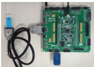
Gambar 4. Potentiostat dan sensor elektrokimia
