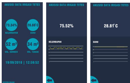
Gambar 11. Hasil Akuisisi Data Sensor pada aplikasi Android
