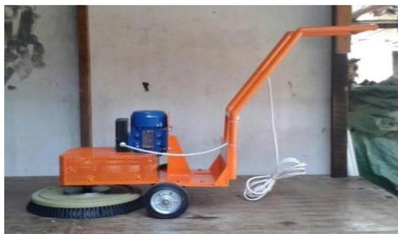
Gambar 3 Mesin sikat karpet mekanik
