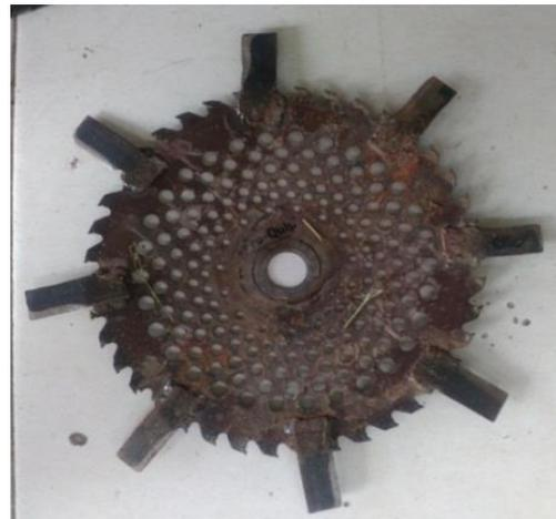
Gambar 9. Mata Pisau dengan pemotongan bertingkat
