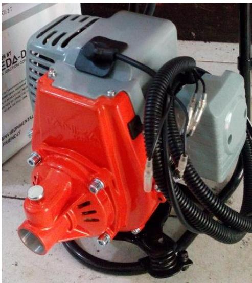
Gambar 8. Motor bakar dua langkah (2 tak)
