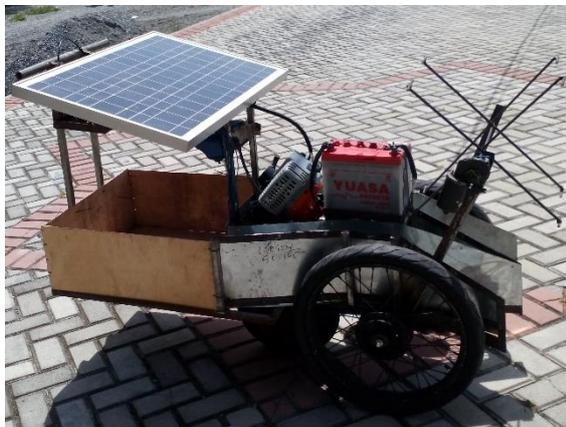
Gambar 12. Tampak Samping Hasil Manufaktur Mesin Panen Padi Dua Lajur
