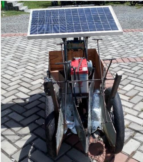
Gambar 11. Tampak Depan Hasil Manufaktur Mesin Panen Padi Dua Lajur
