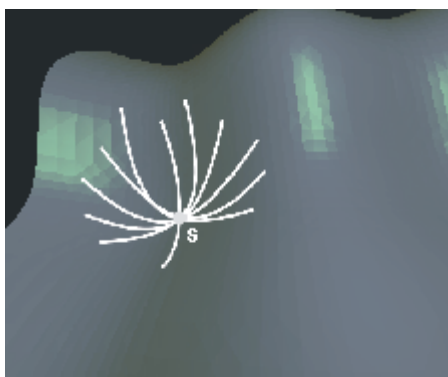
Gambar 5. Perhitungan kurvatur pada titik s melibatkan semua kurva pada bidang 3D yang melalui titik s
