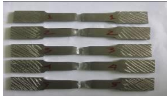
Gambar: 3. Bentuk dari Spesimen uji Tarik Standar ASTM D638 M setelah Pengujian Tarik
