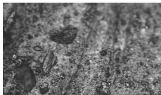
Gambar: 5. Bentuk Porositas Pada Spesimen 2
