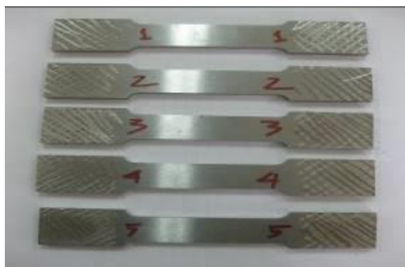
Gambar: 2. Bentuk Spesimen Uji AISI 1050,
