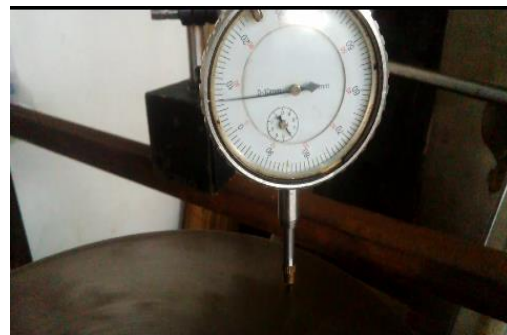
Gambar 4 Mengukur Penyimpangan Putaran
