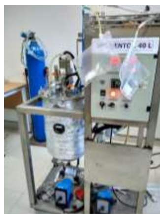
Gambar 1. Fermentor Produksi Biogas Kapasitas 40 L (Patent ID No. P00201000740)
