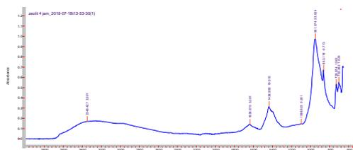
Gambar 5. Hasil Analisa FTIR Zeolit Dengan Waktu Tenggat 4 Jam
