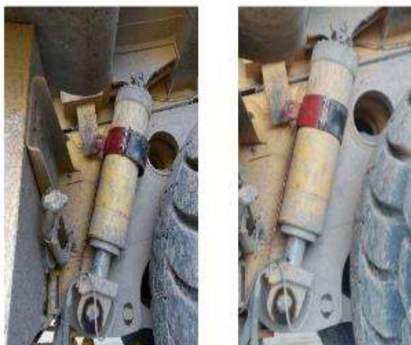
Gambar 23. Special Tool Selesai Terpasang Setelah uji coba dilakukan, special tool terpasang dengan baik dan hanya membutuhkan waktu 15 menit untuk memasangnya.
