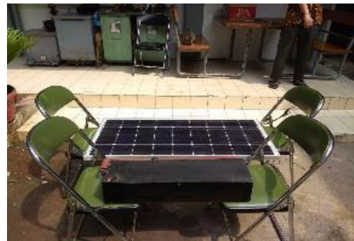
Gambar 3. Pengujian Panel Surya Monocrystalline 100 Wp pada alat sampah pintar dengan pencahayaan matahari langsung
