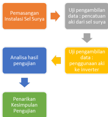
Gambar 3.1 Flowchart Penelitian Karakteristik Sel Surya
