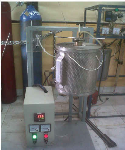
Gambar 1 Alat Proses Aktivasi pada Pembuatan Karbon Aktif
