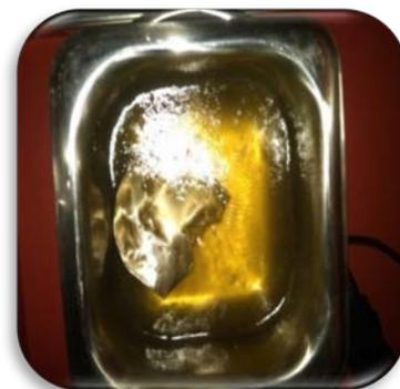
Gambar 4. Proses pembersihan sampel pada ultrasonic cleaner
