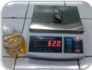
Gambar 5. Pengukuran berat sampel potongan tangki
