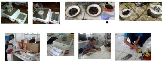
Gambar 9. Proses pembuatan benda uji
