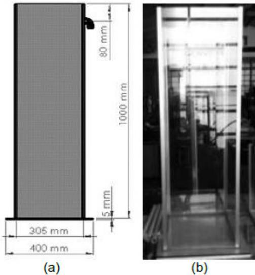
Gambar 3. seksi uji (a) Desain; (b) bentuk fisik
