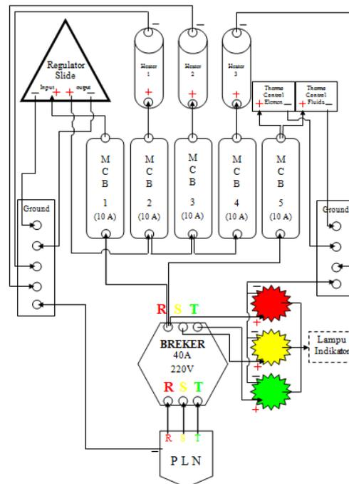
Berikut ini merupakan Gambar model alat uji teras reaktor yang sudah selesai dibuat. Pelaksanaan uji coba model alat uji ini perlu dilakukan guna untuk mengetahui alat uji berfungsi sebelum dilakukannya pengujian eksperimental. Pelaksanaan uji coba dilakukan pada beban maksimal silinder pemanas yaitu 200 Volt dalam waktu satu jam. Setelah dalam waktu satu jam pelaksanaan uji coba tidak
