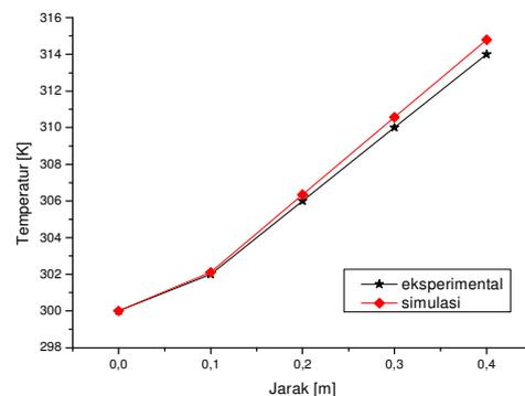
Gambar 18. Hubungan antara temperatur fluida terhadap jarak atau ketinggian dari batang silinder untuk melihat perbedaan dari pengujian eksperimental dengan simulasi dengan fluks panas 500000 W/m<sup>2</sup> pada kecepatan aliran fluida 0,3 m/s.
