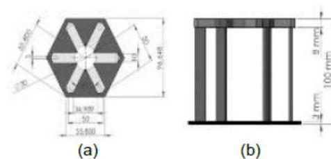
Gambar 6. Desain distributor (a).Tampak atas dan (b). tampak depan
