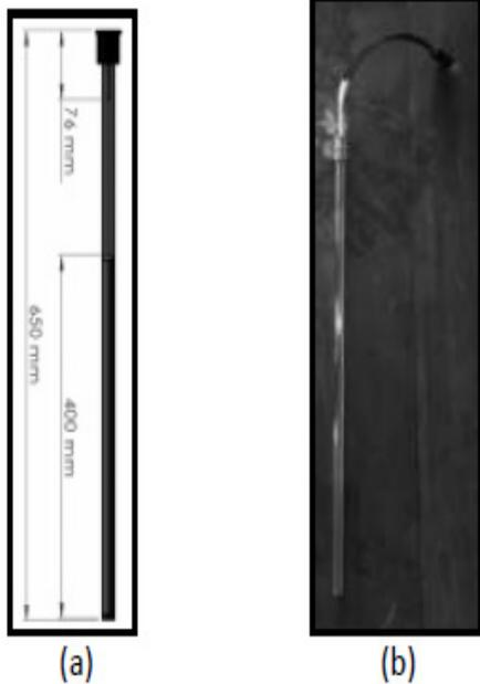
Gambar 12. Silinder pemanas (a) desain; (b) bentuk fisik
