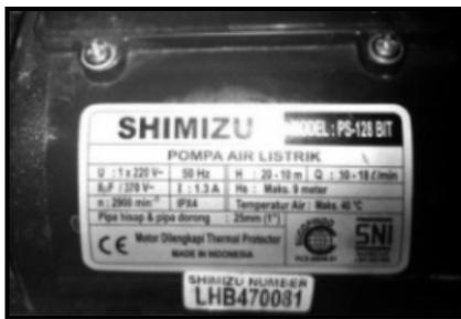
Gambar 14. Pompa Sentrifugal
