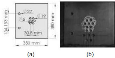
Gambar 10. Penggantung silinder, (a). Desain, (b). bentuk fisik
